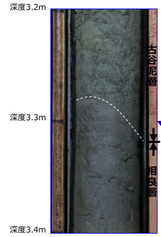
【古谷泥層と相良層の不整合面】
