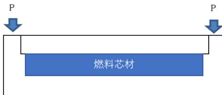
図2 燃料要素構造 (断面図)
