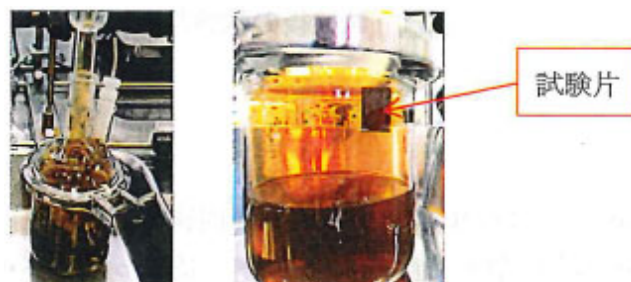
図 1 炭素鋼の NO x ガス曝露試験の状況
