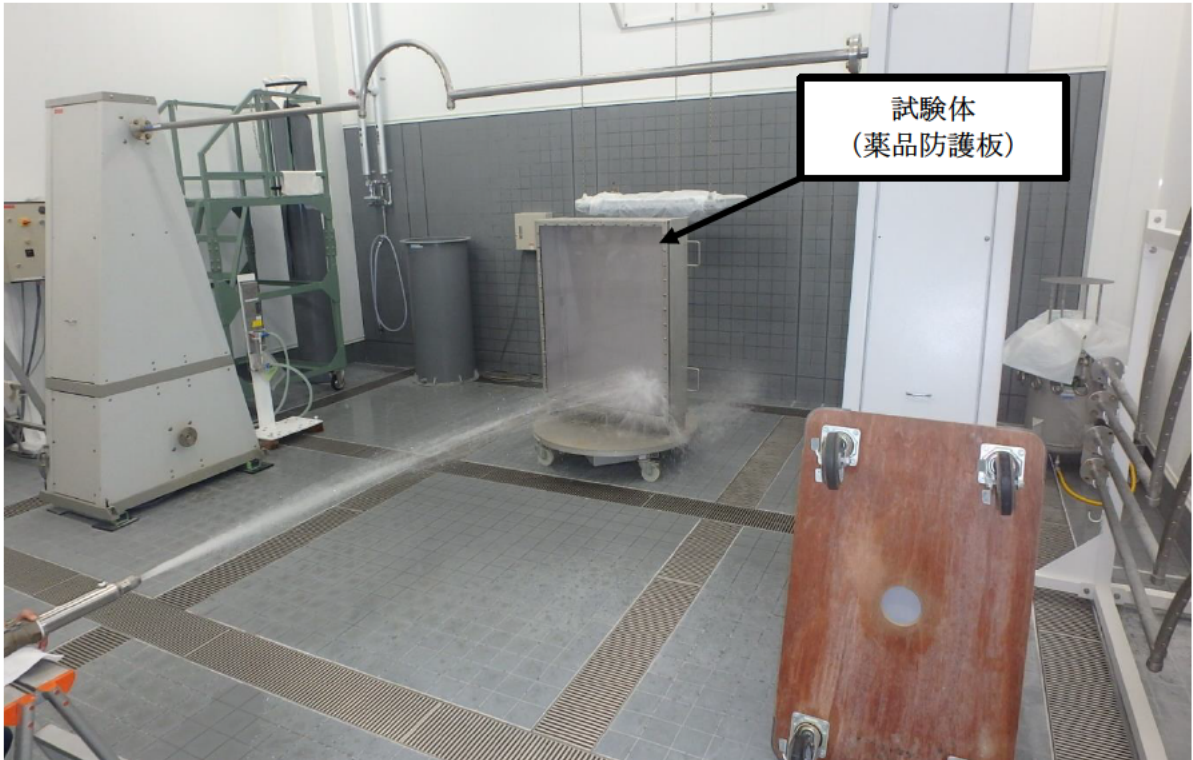
第4図 耐水試験の例（薬品防護板）
