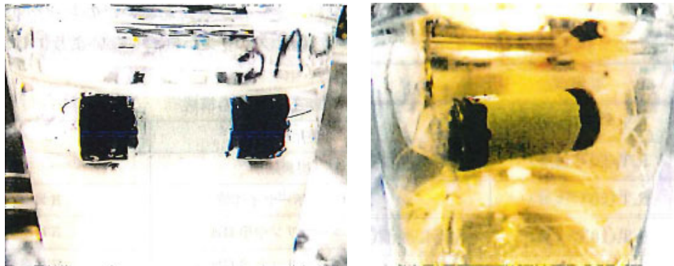
図2 塗裝配管の浸漬・曝露試験状況
