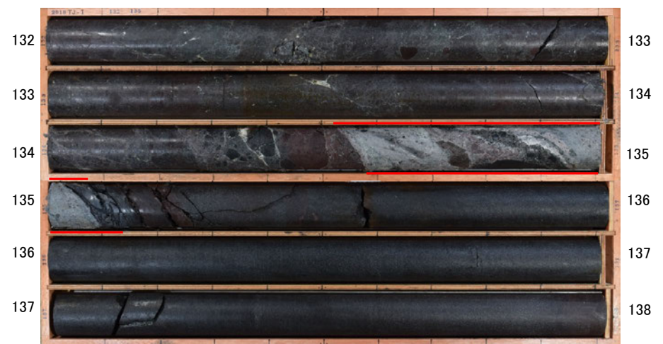
コア写真(深度132~138m) 〓 破碎部
