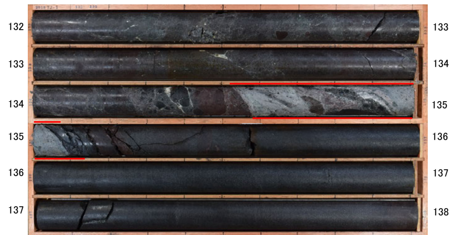
コア写真(深度132~138m) — 破砕部
