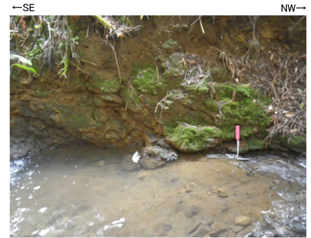
露頭写真② 風化した安山岩が分布し、断層は認められない
