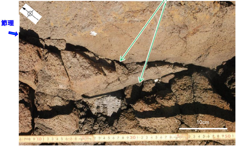
写真②拡大 谷地形(2)延長位置の不連続な節理
