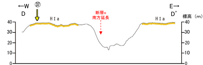
地形断面図(H:V=1:4) (航空レーザ計測データにより作成)
