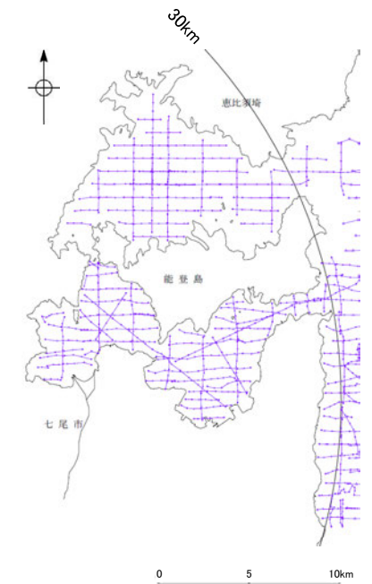
上図凡例 海上保安庁水路部: スパーカー・シングルチャンネル 七尾湾調査海域の音波探査航跡図※
