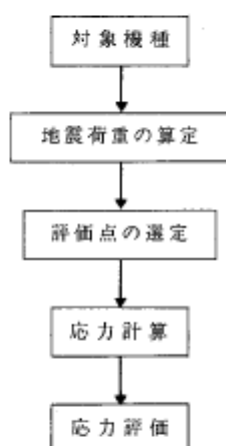
図 6.6.1-1 応力・強度解析の基本的な流れ
