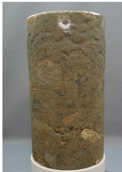
図 4.2.3-3 繰返し三軸試験後の供試体写真（改良地盤④）
