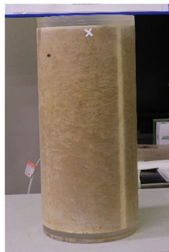
改良地盤⑧の供試体 室内試験実施前の状況写真
