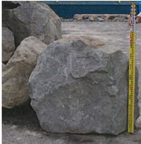
被覆石の寸法（1，2号機北側護岸）
