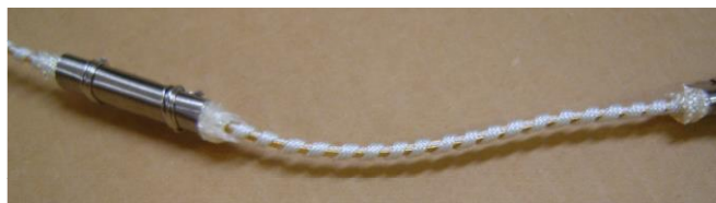
第 2.1.2 図 通電式（リボン型）のナトリウム漏えい検出器の構造概要
