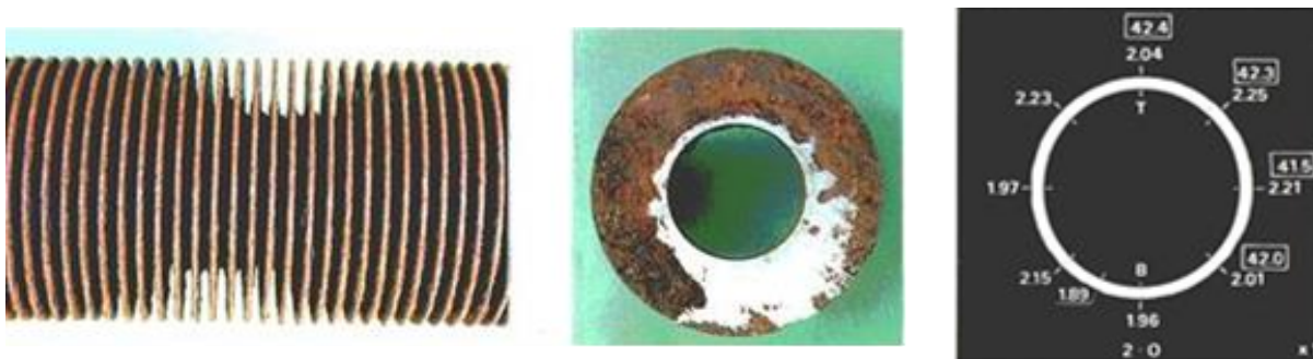
第2図 過去の主冷却器伝熱管の肉厚確認結果（一例）
