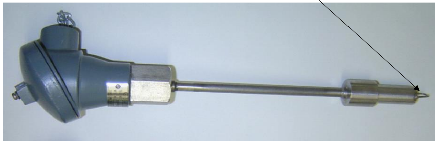
第 2.1.1 図 通電式（プラグ型）のナトリウム漏えい検出器の構造概要
