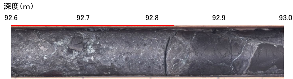
コア写真 = 破碎部
