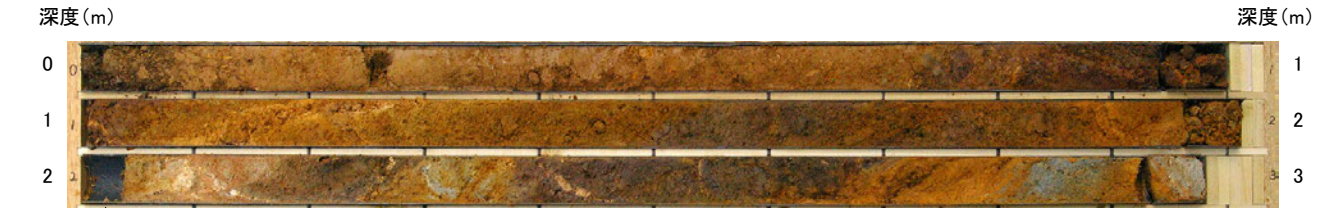
コア写真i 打撃により圧縮された区間
