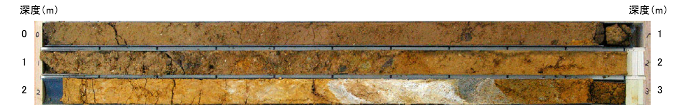
コア写真j 打撃により圧縮された区間
