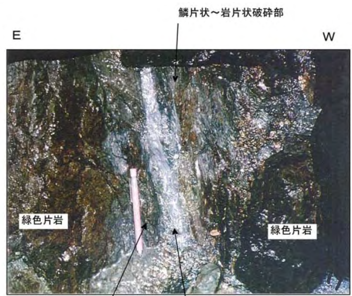
鱗片状～岩片状破砕部 f. N2E75W 軟質な粘土状破砕部2cm 条線のレイクは70° S
