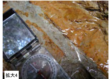
● 泥岩中の断層面の連続性はやや不明瞭で平面性は低い。また幅約5mmの砂礫岩を挟在しているが、粘土状破碎部を伴わない。 ● 砂礫岩は、周囲の砂岩層と同様の固結の程度である。
