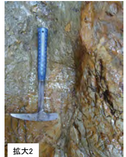
● 砂岩と泥岩の境界の断層面の連続性はやや不明瞭でしばしば分岐し、平面性は低い。また幅約5mmの砂礫岩を挟在しているが、粘土状破碎部を伴わない。 ● 砂礫岩は、周囲の砂岩層と同様の固結の程度である。
