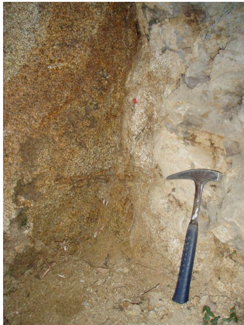
写真4 断層面の癒着した断層(拡大)
