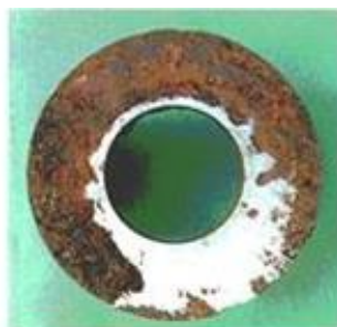
第2図 過去の主冷却器伝熱管の肉厚確認結果（一例）
