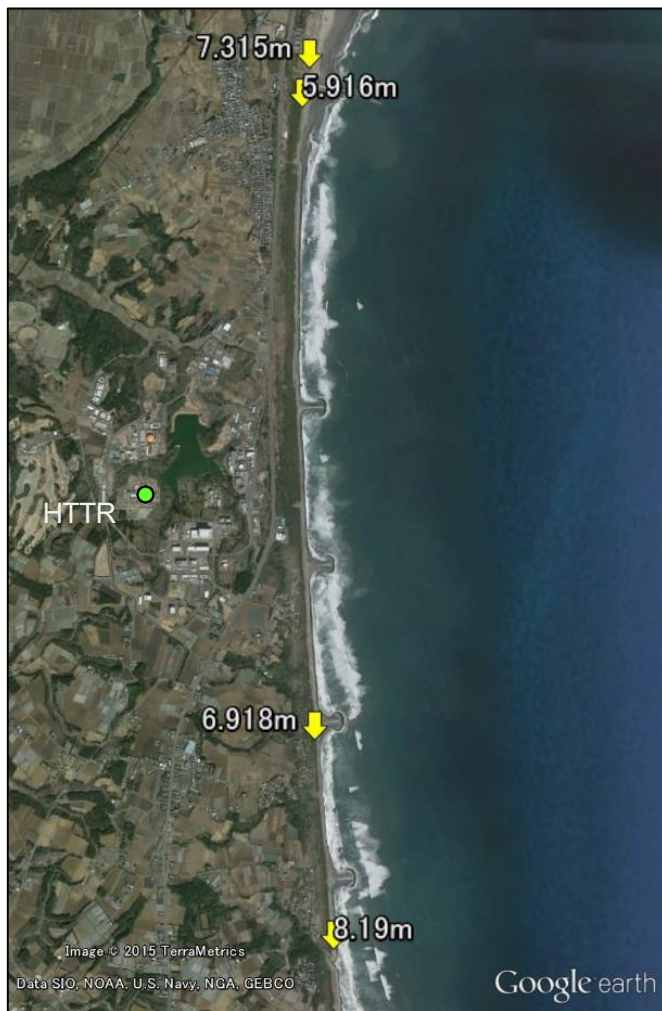
2011年東北地方太平洋沖地震津波による敷地近傍の痕跡高 (東北地方太平洋沖地震津波合同調査グループ(2011)による)
