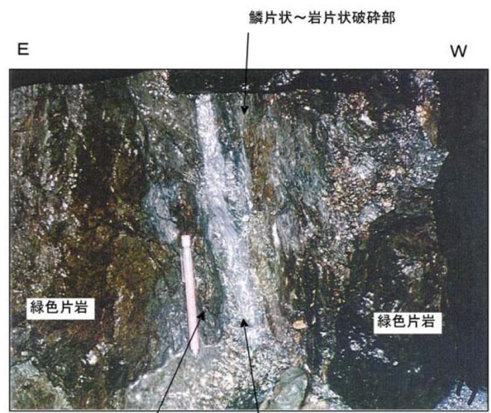
鱗片状～岩片状破碎部 f. N2E75W 軟質な粘土状破碎部2cm 条線のレイクは70° S
