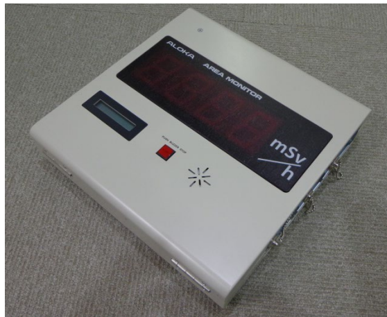
第5図 緊急時対策所エリアモニタ
