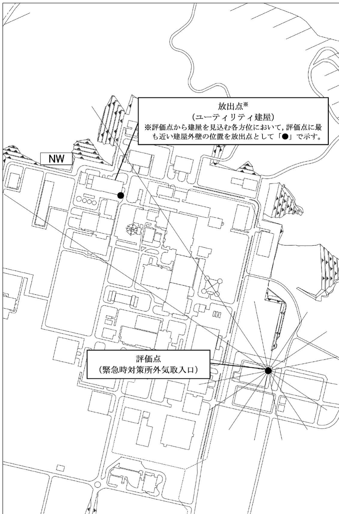
第 12 図 緊急時対策所の外気取入口とユーティリティ建屋 との位置関係
