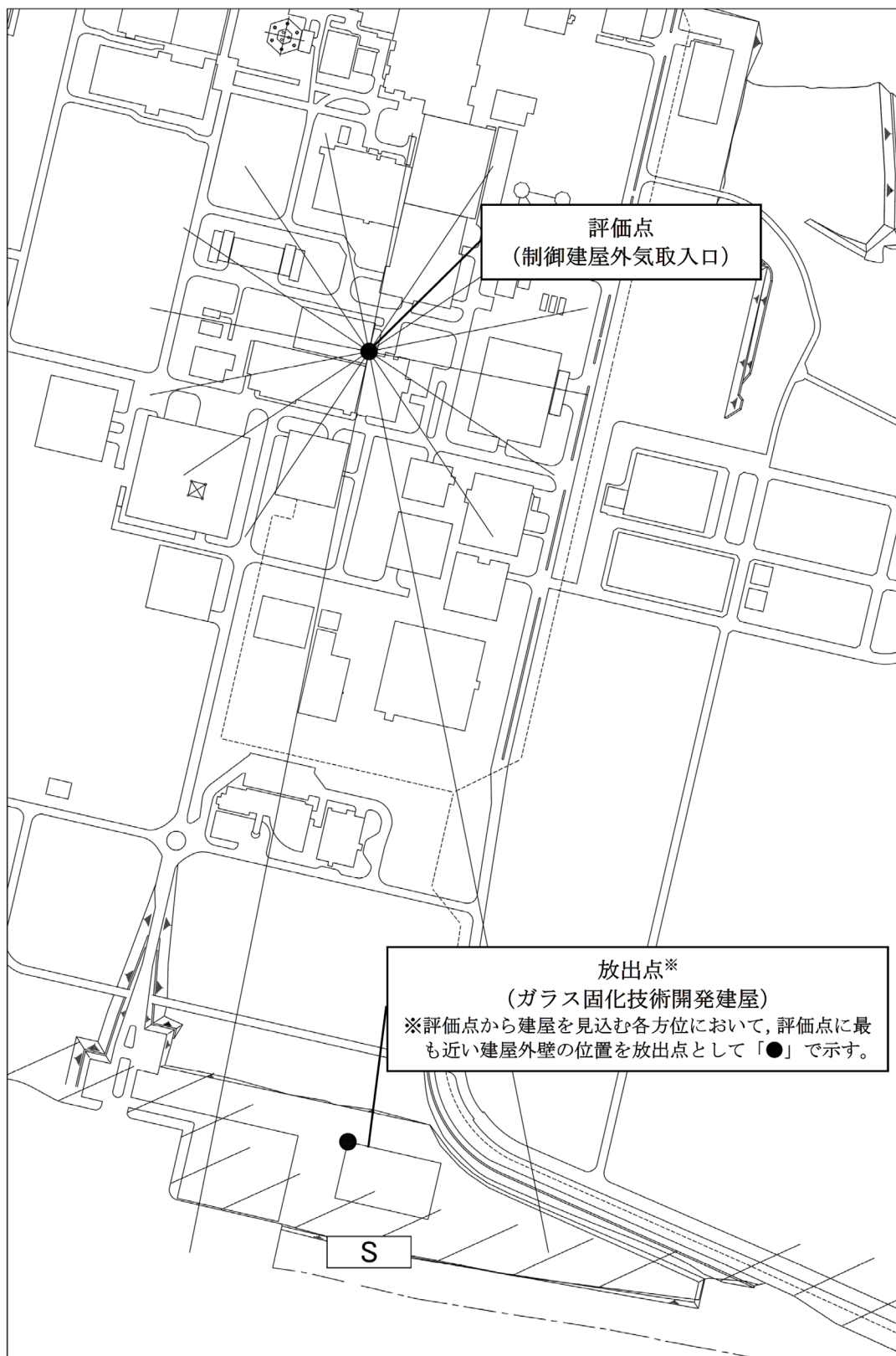
第 11 図 中央制御室の外気取入口とガラス固化技術開発建屋との位置関係
