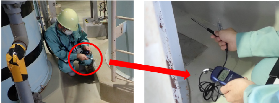
第2図 敷地内の固定施設周りの風速及び温度の測定状況 (第2 一般排水処理建屋)
