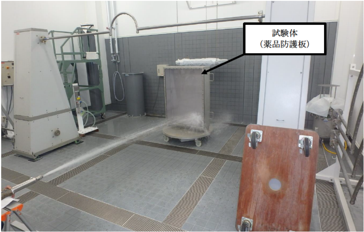
第4図 耐水試験の例（薬品防護板）
