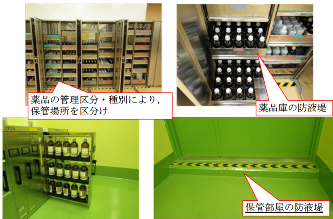
第3.2図 分析用試薬の保管状況
