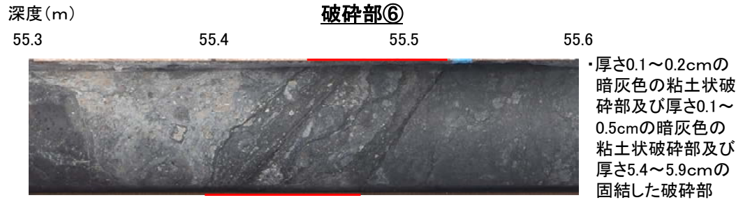
コア写真 = 破碎部
