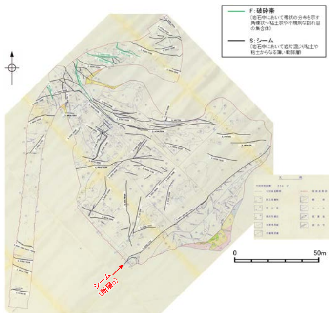
図1 大坪川ダム基礎掘削面スケッチ (スケッチの観察結果は次々頁)
