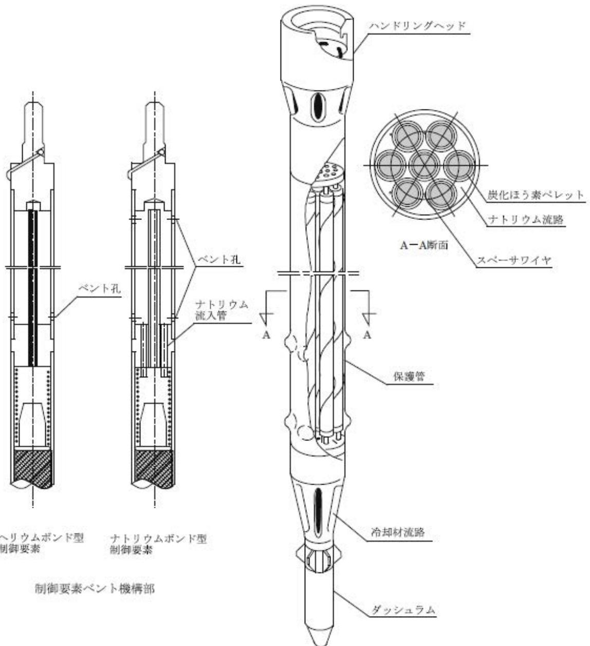
第 4.1.1 図 制御棒及び後備炉停止制御棒
