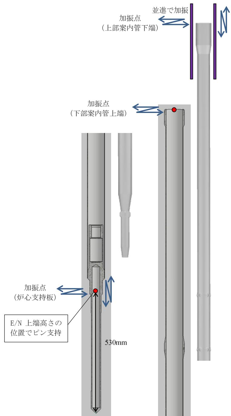
第3.4図 解析モデルにおける加振箇所
