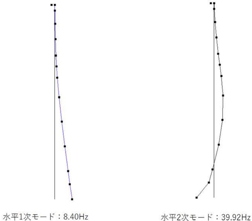
第2.3図 炉心上部機構の振動モード
