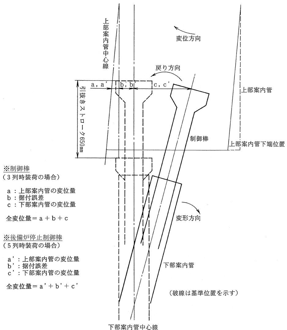
第 1.1 図 地震時水平方向変位概略<sup>[2]</sup>
