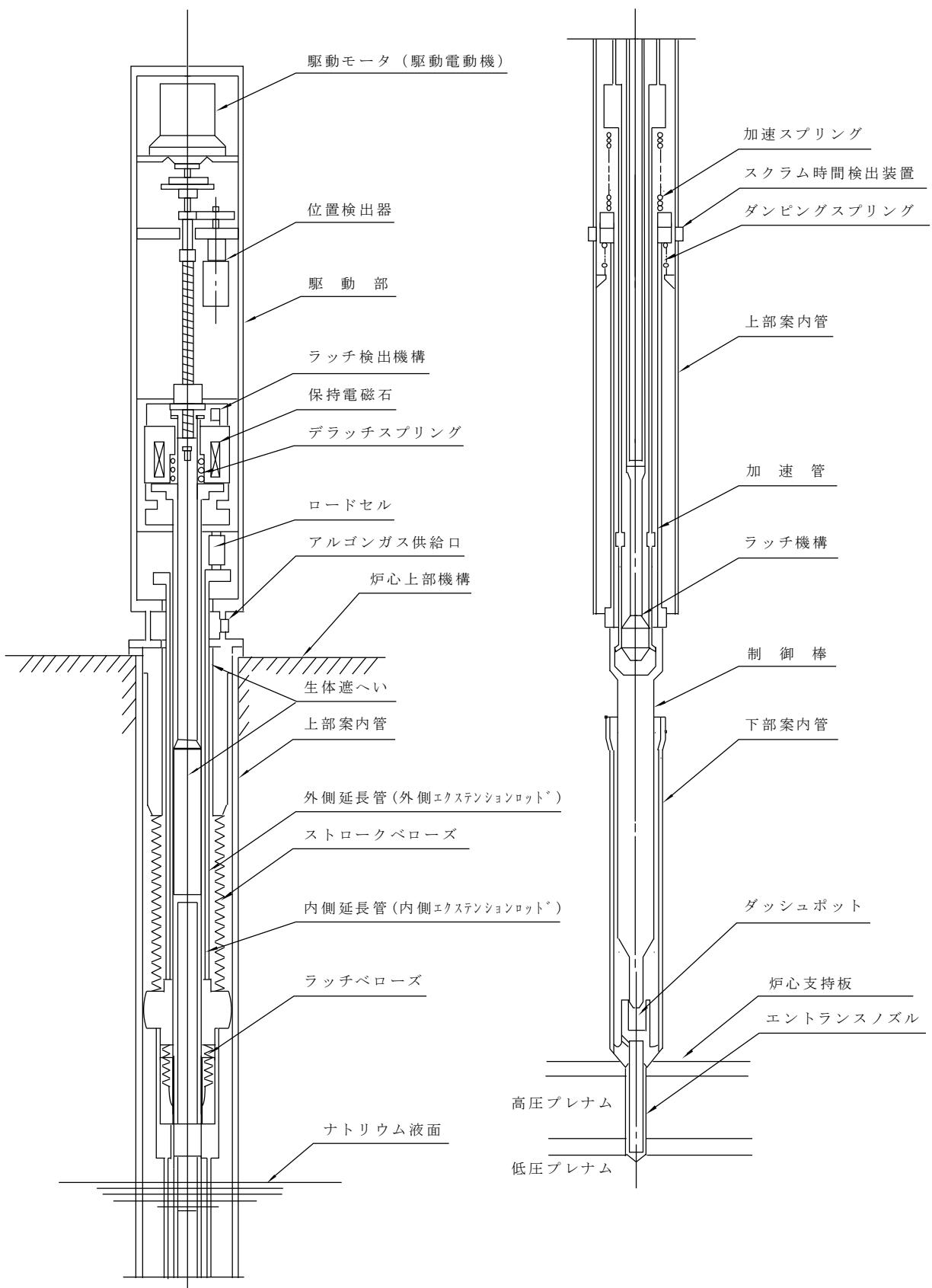
第4.1.2図 制御棒駆動機構及び後備炉停止制御棒駆動機構
