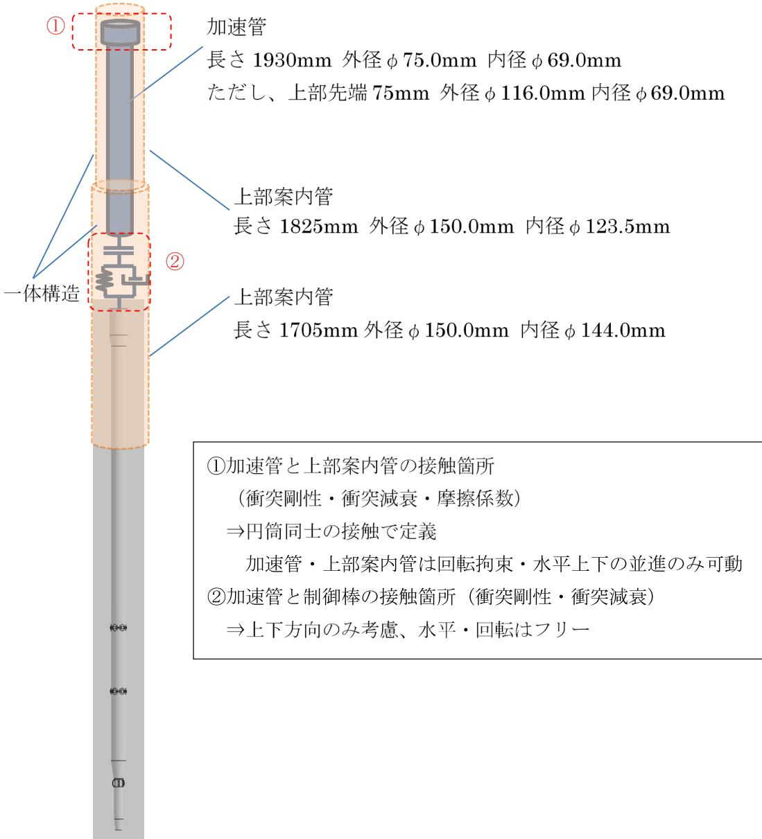
第 3.3 図 加速管の接触条件
