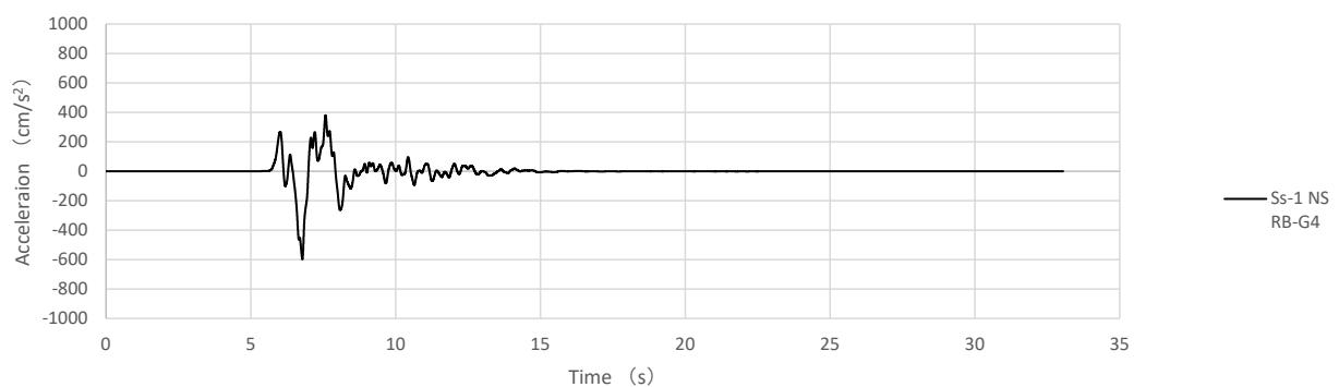
第 2.4 図 原子炉建物 BM1F 加速度時刻歴 (Ss-1、NS 方向)
