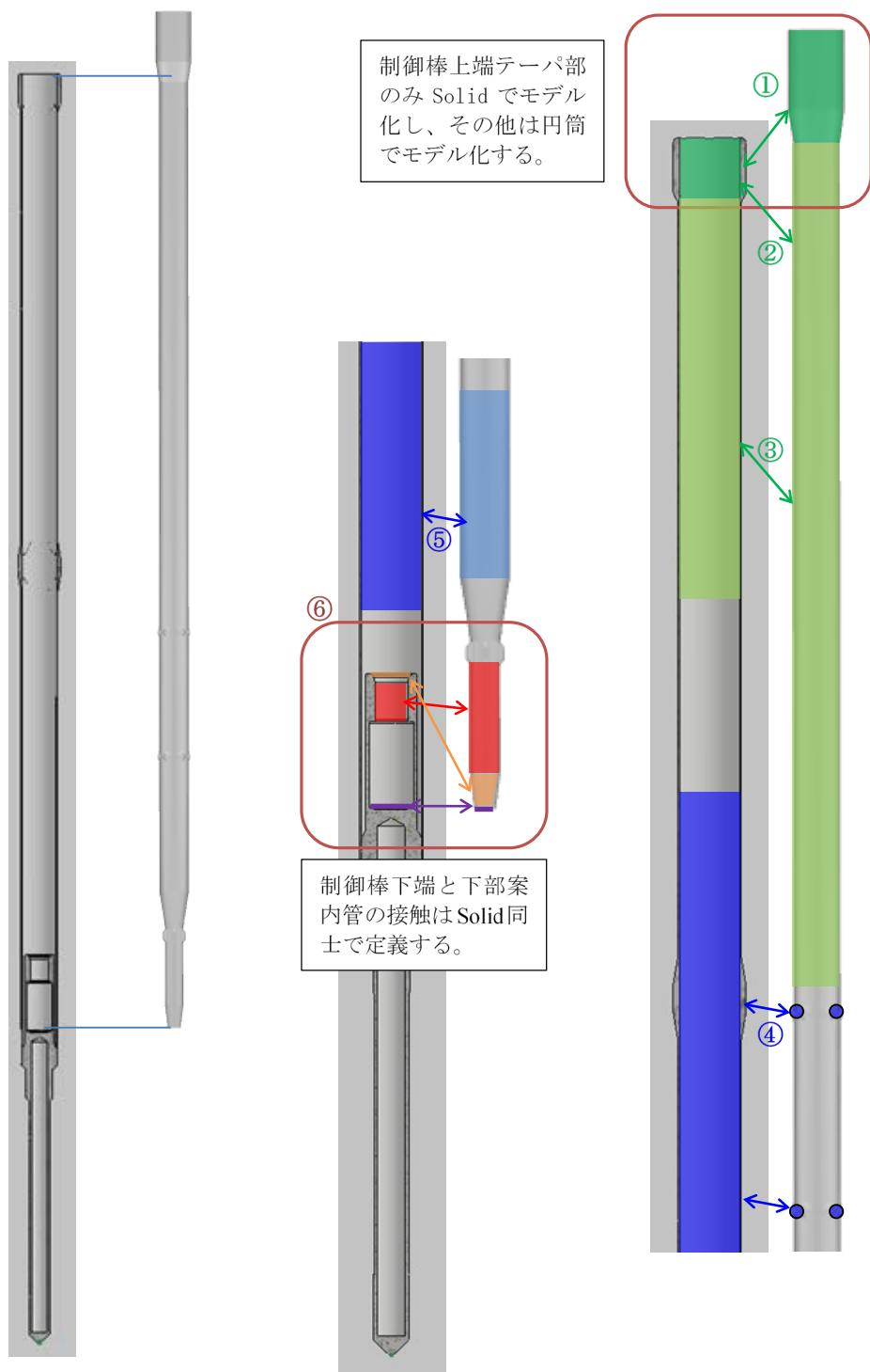
第3.2図 制御棒の接触条件（着座時）
