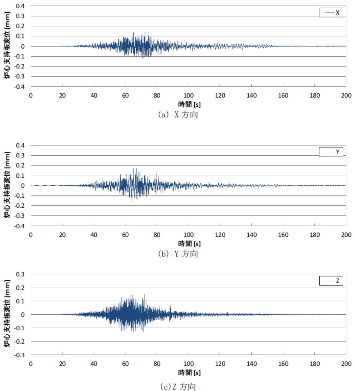
第 3.20 図 加振波 (Ss-5 波、炉心支持板変位)
