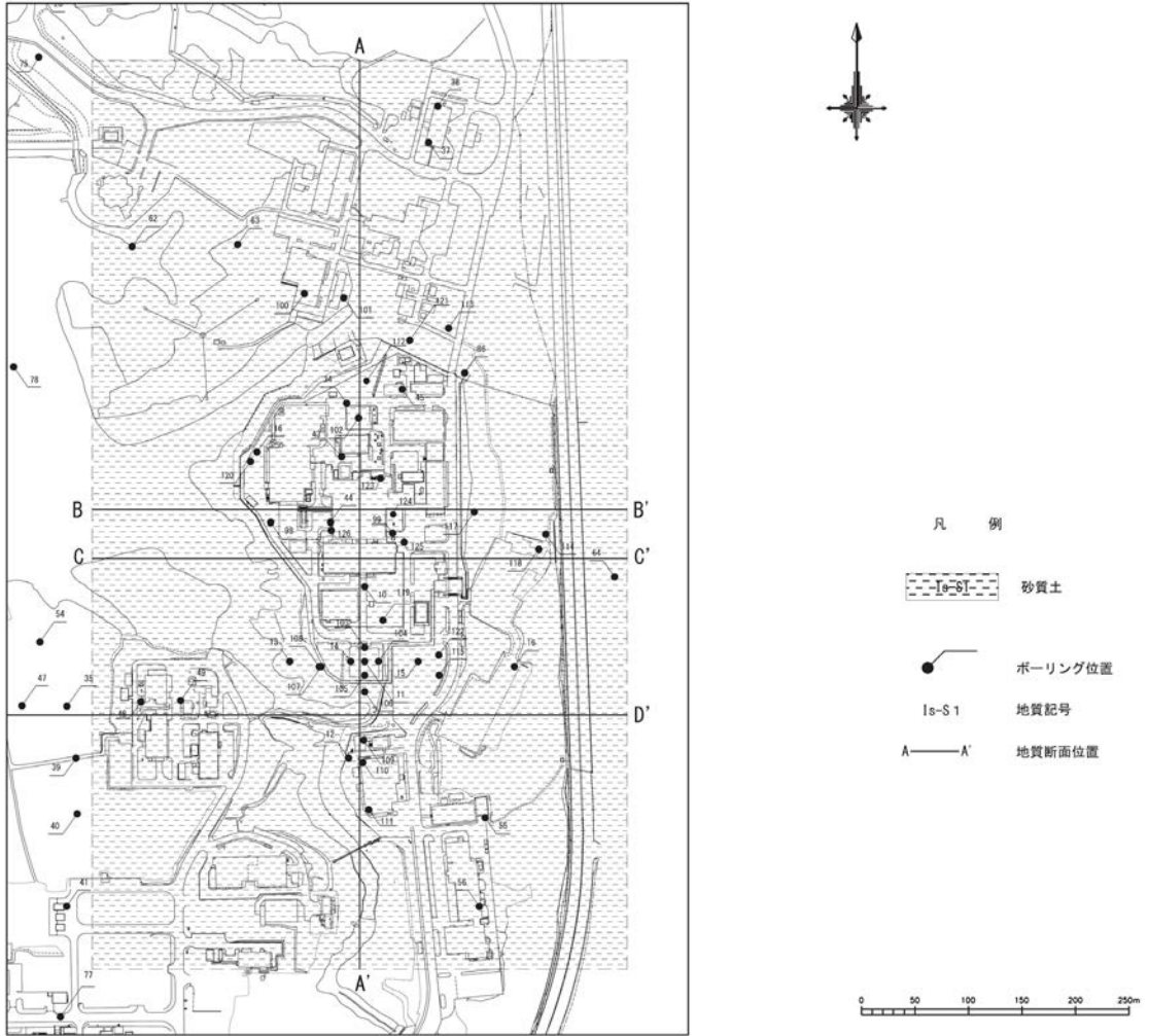
第 1 図 原子炉施設設置位置付近の水平地質断面図
