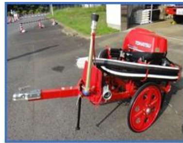
[可搬型消防ポンプ]
