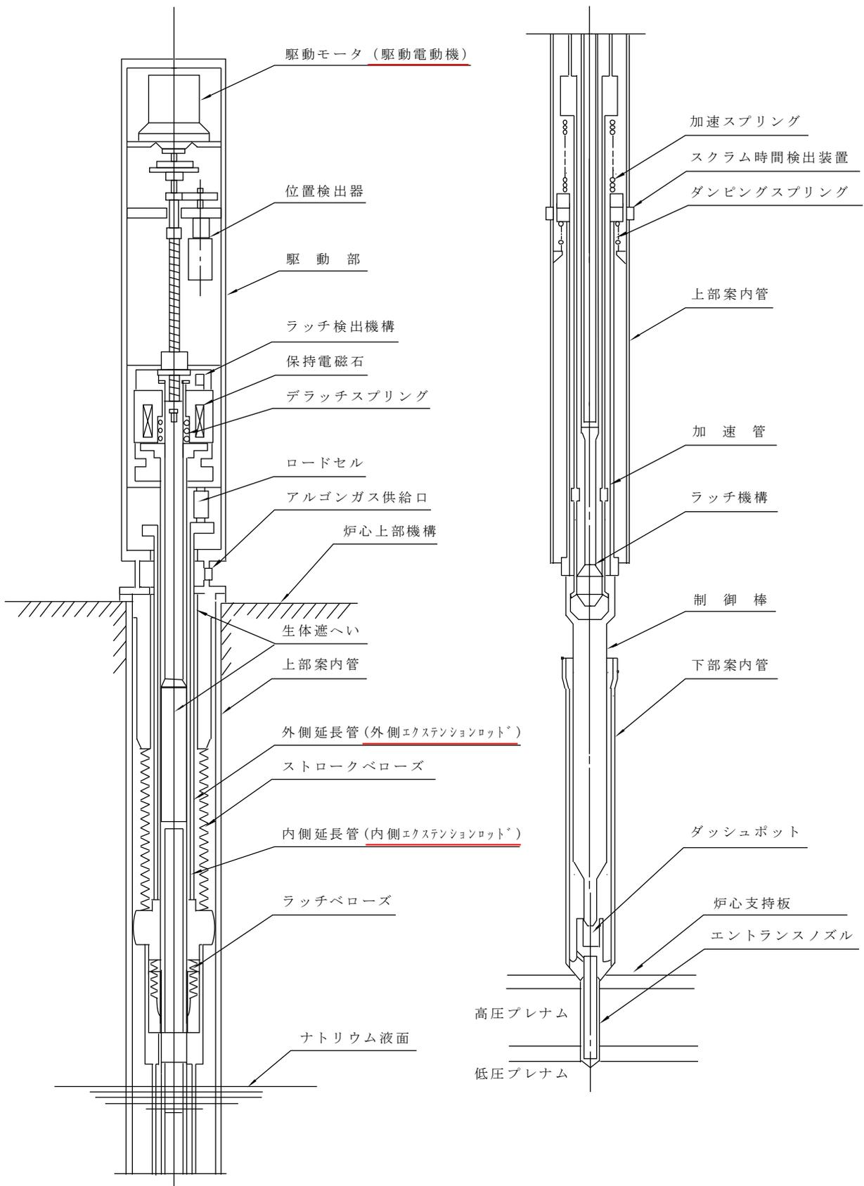
第 3.9.2 図 制御棒駆動機構
