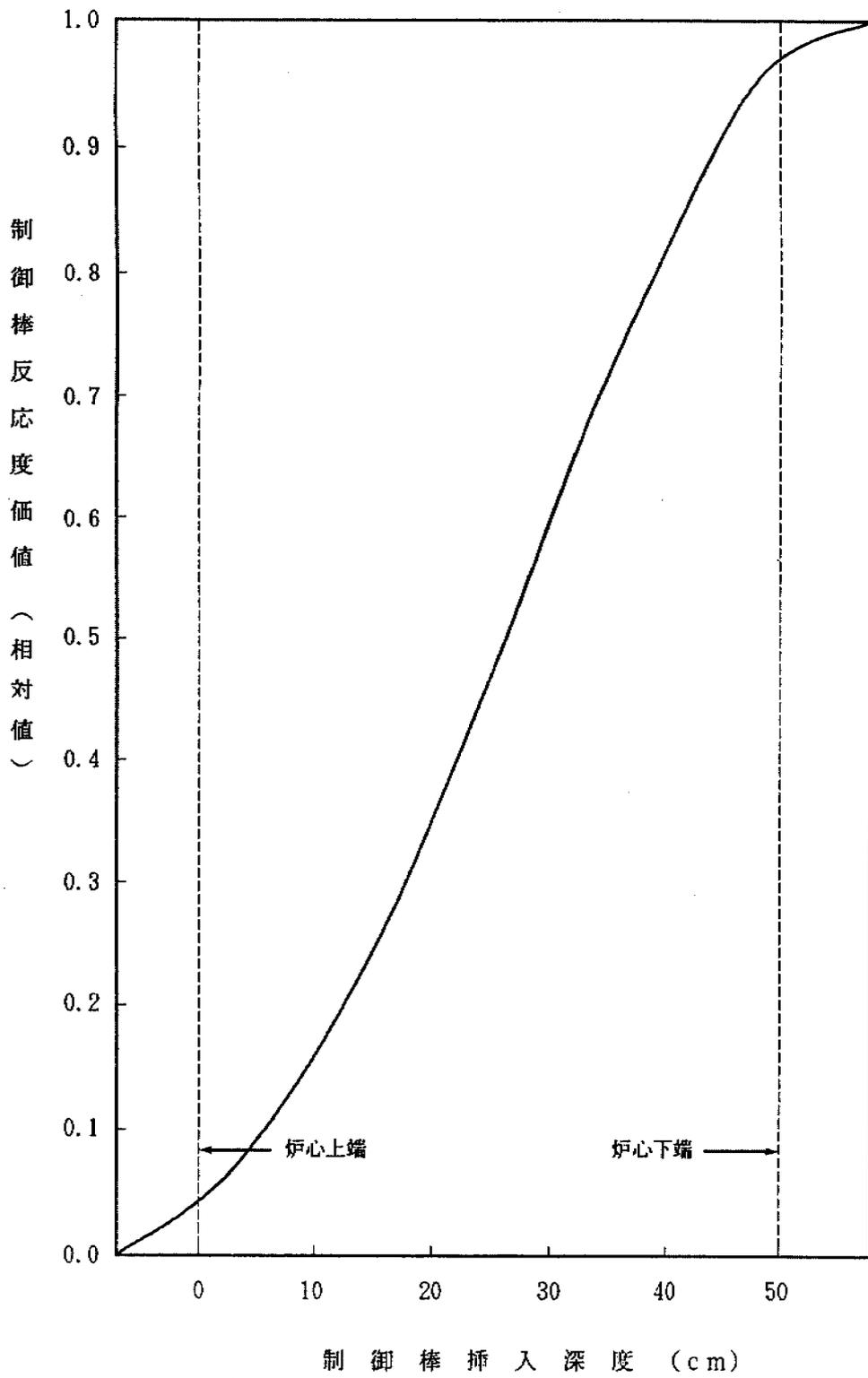
第VII-2図 制御棒ストローク曲線
