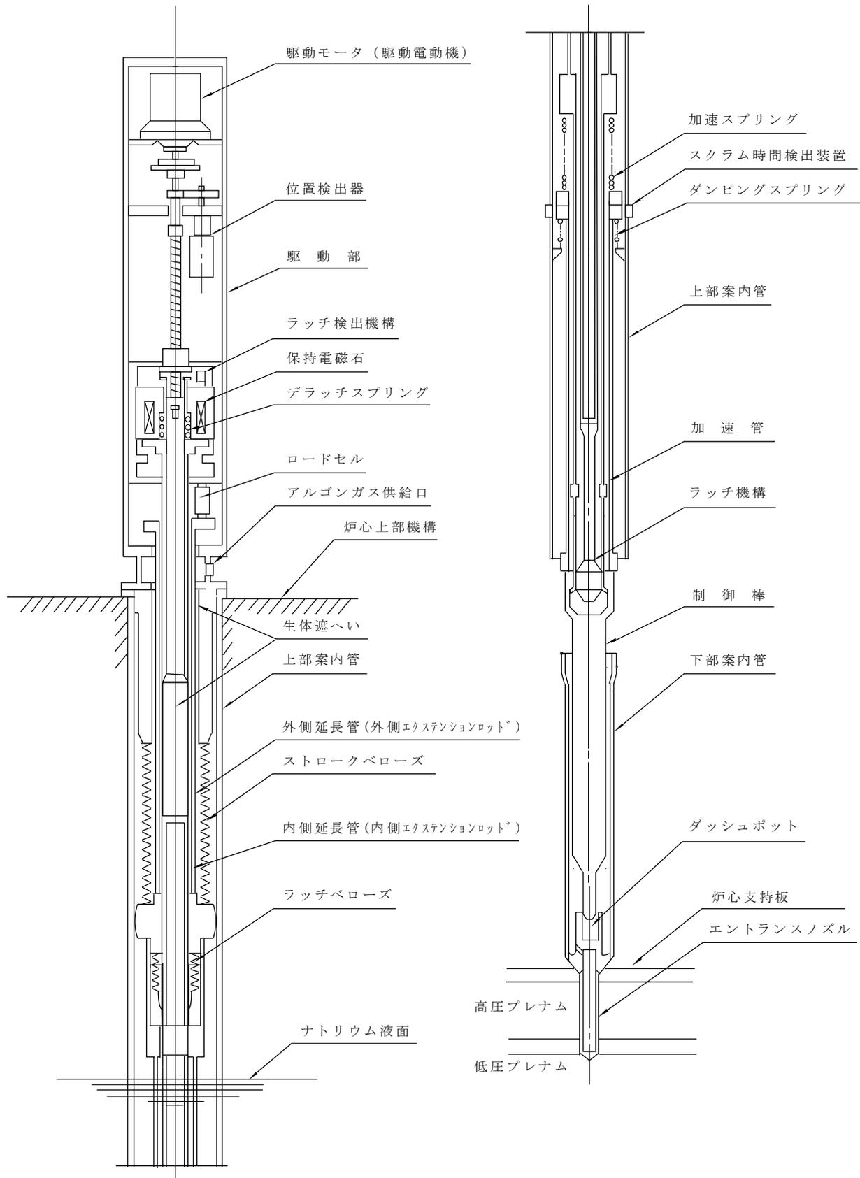
第 4.3.1 図 制御棒駆動機構
