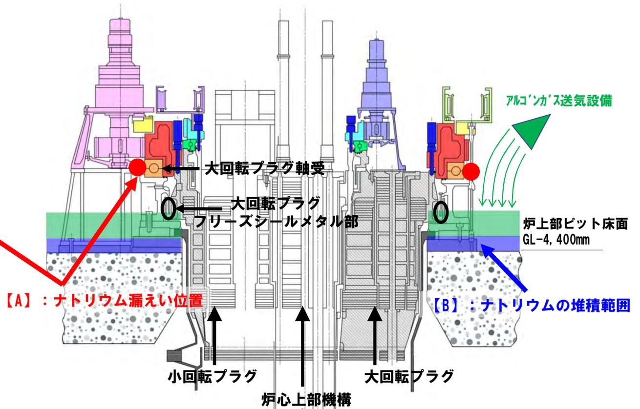
※：ナトリウムプールの温度が十分に低下した後に空気置換して噴出したナトリウムを除去する。
