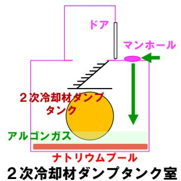
※：ナトリウムプールの温度が十分に低下した後には空気置換して漏えいしたナトリウムを除去する。
