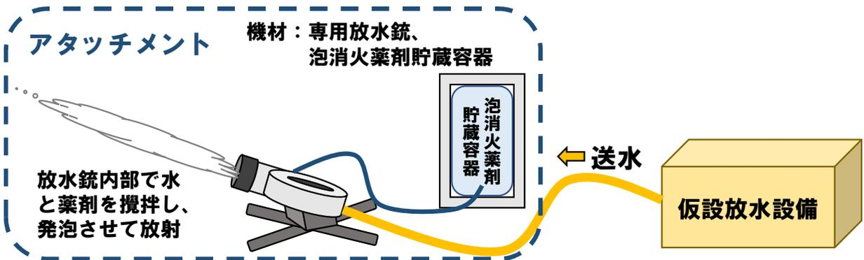
ナトリウム火災の可能性を排除できない場合は、特殊化学消火剤又は乾燥砂を遠隔で散布することにより消火する。
