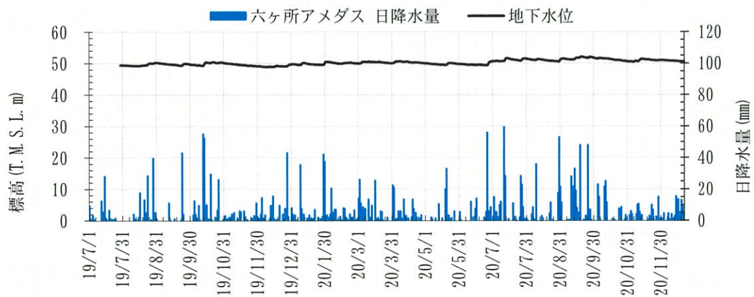
第 1. -1 図 (10) GW-15 孔における地下水位観測記録と降水量データ
