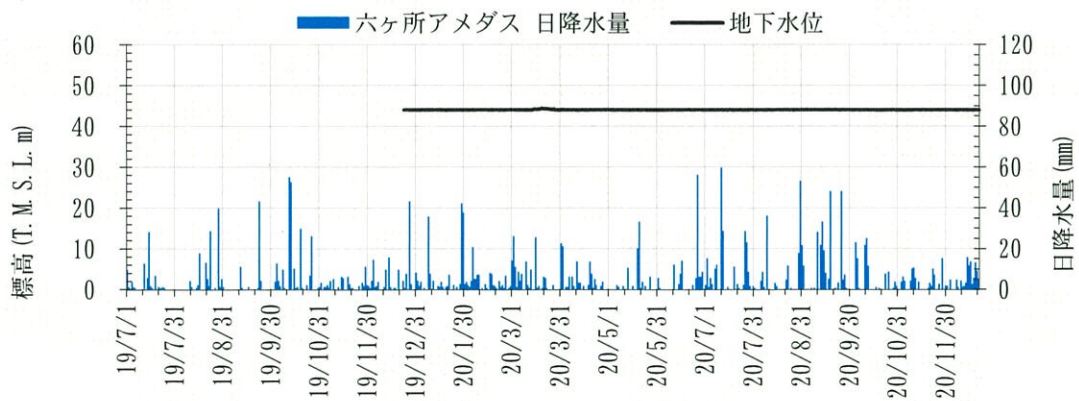
第 1. -1 図 (19) GW-S2 孔における地下水位観測記録と降水量データ
