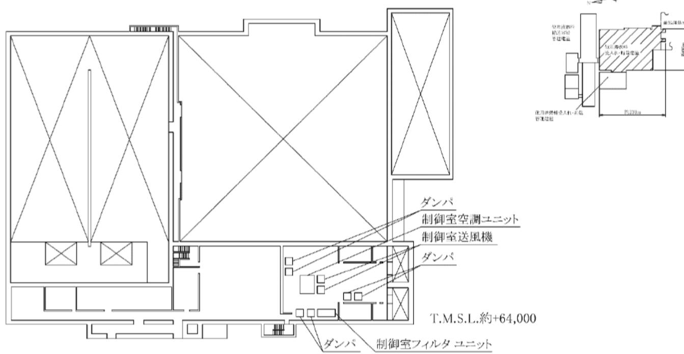
第1. 2-4図 使用済燃料受入れ・貯蔵建屋機器配置概要図(地上2階)
