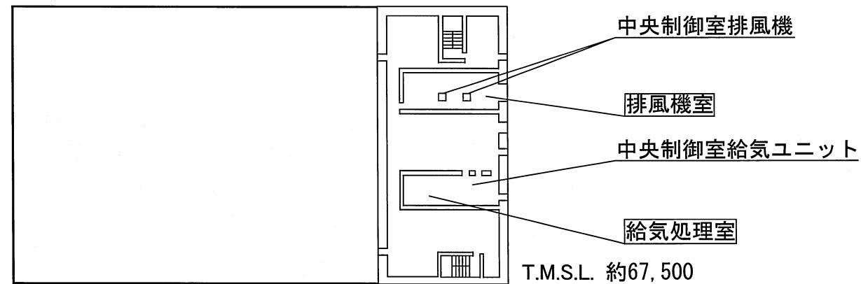
第1・2-3図 制御建屋機器配置概要図（地上3階）
