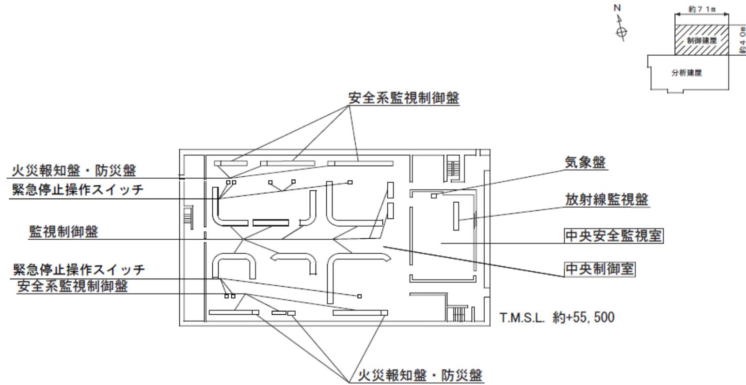
第 1 . 2 - 2 図 制御建屋機器配置概要図（地上 1 階）
