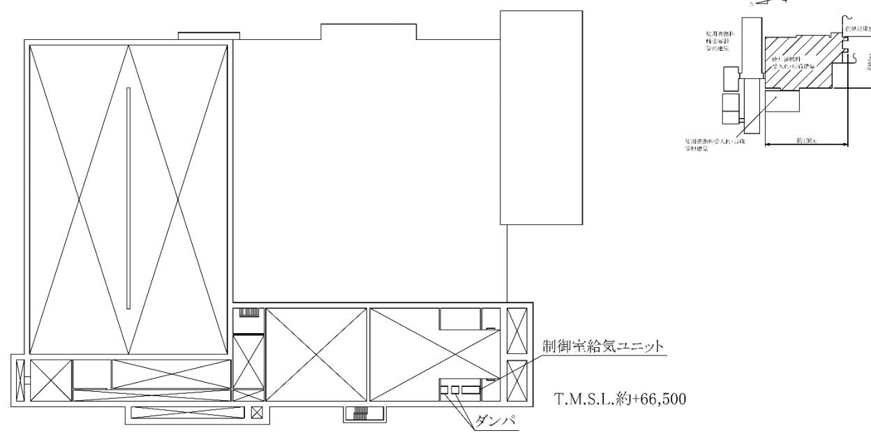
第1. 2-5図 使用済燃料受入れ・貯蔵建屋機器配置概要図(地上3階)
