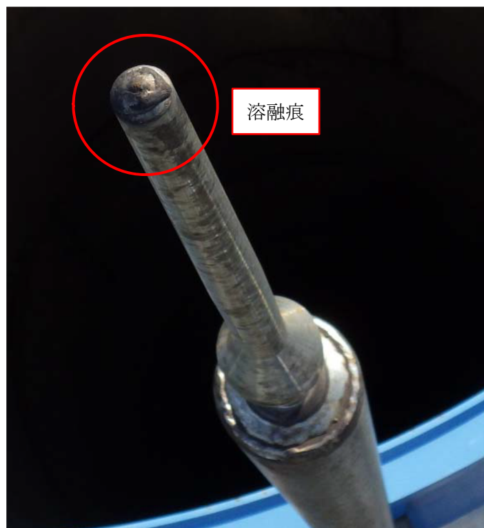
別添2-第1図 落雷による溶融痕
