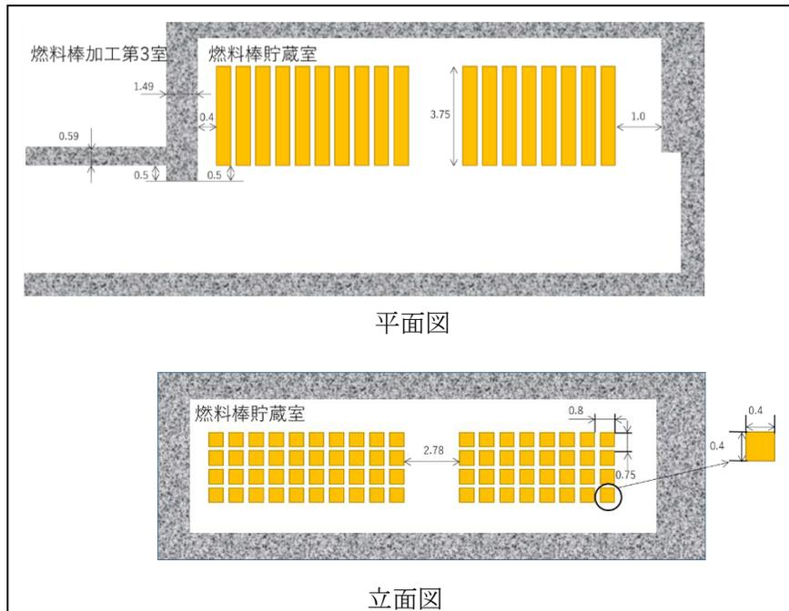
■は貯蔵マガジンを表している。貯蔵マガジンが存在する空間の体積と燃料棒加工第3室側の面積を保存した円筒にモデル化している。中央にある貯蔵マガジンの間隔が 2.78m の箇所については、線源が密集して安全側の評価となるように、貯蔵マガジンの間隔を 0.8m として取り扱う。
