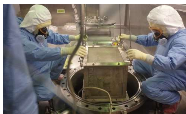
洗浄設備 (作業セル内部(装荷作業))
