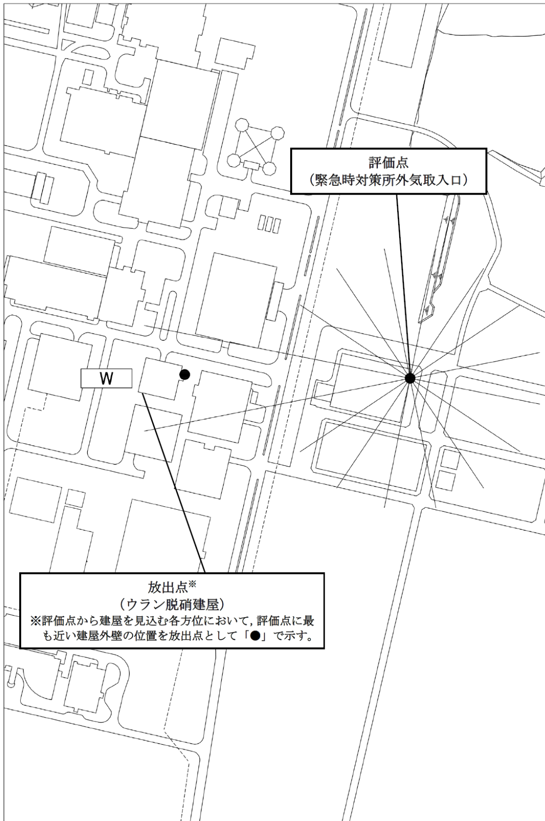
第6図 緊急時対策所の外気取入口とウラン脱硝建屋との位置関係
