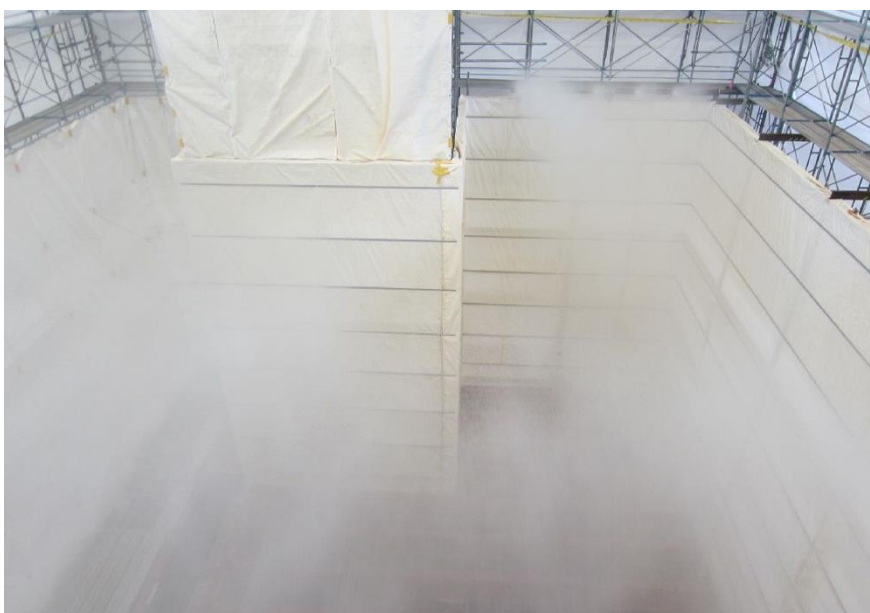
図 1-8 スプレー状態の試験状況（スプレー量：120m 3 /h）
