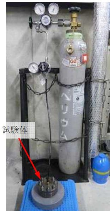
図5 He気密確認試験状況
