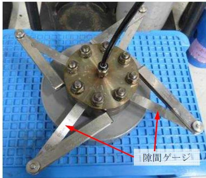
図6 He気密試験時開口模擬 (隙間ゲージ使用)
