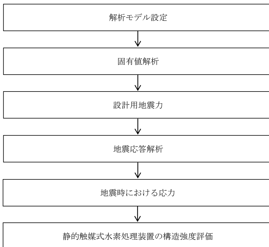
図 2-1 静的触媒式水素処理装置の耐震評価フロー
