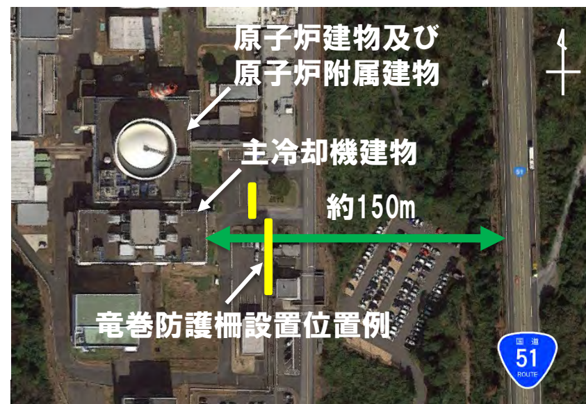
図 竜巻防護柵の設置位置例
