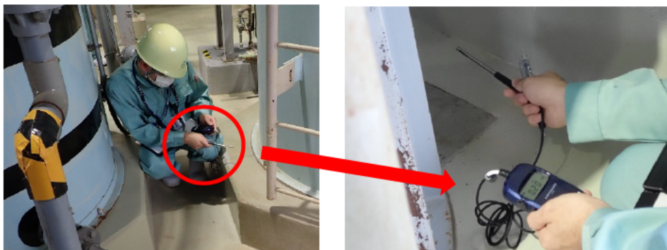
第2図 敷地内の固定施設周りの風速及び温度の測定状況
