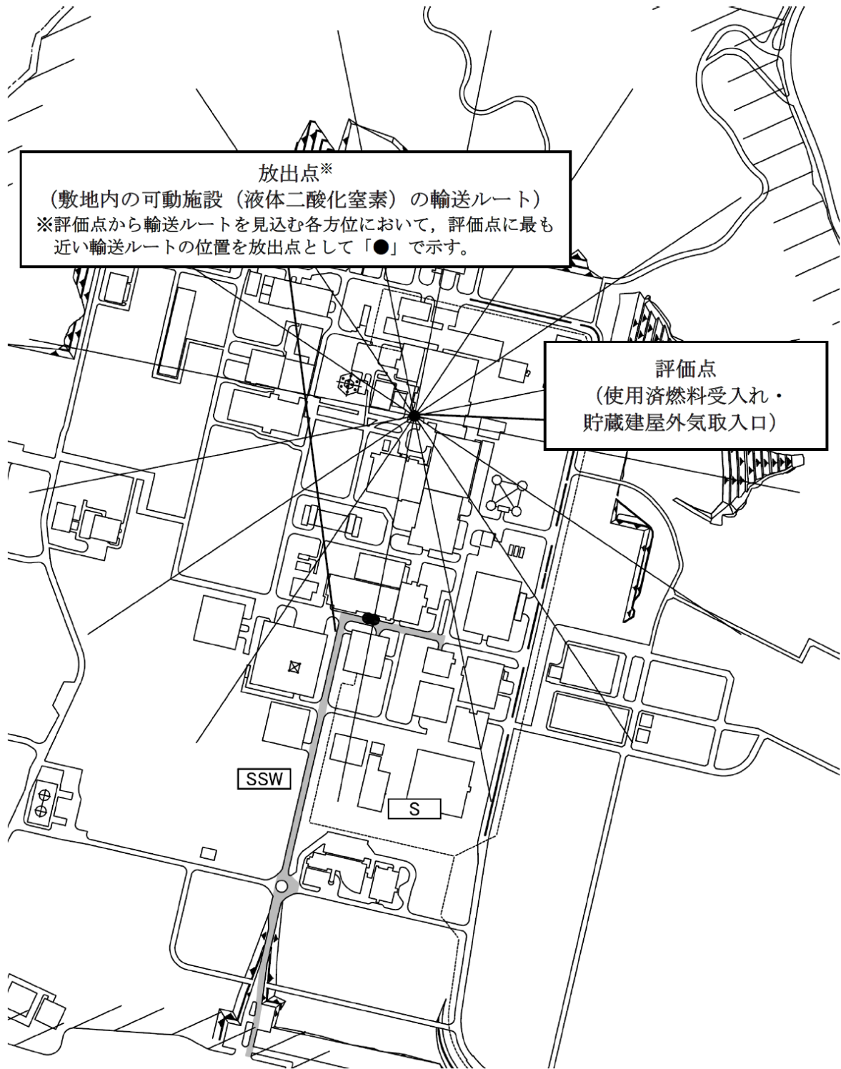
第2図 使用済燃料の受入れ施設及び貯蔵施設の制御室と敷地内の可動施設 (液体二酸化窒素) の輸送ルートとの位置関係
