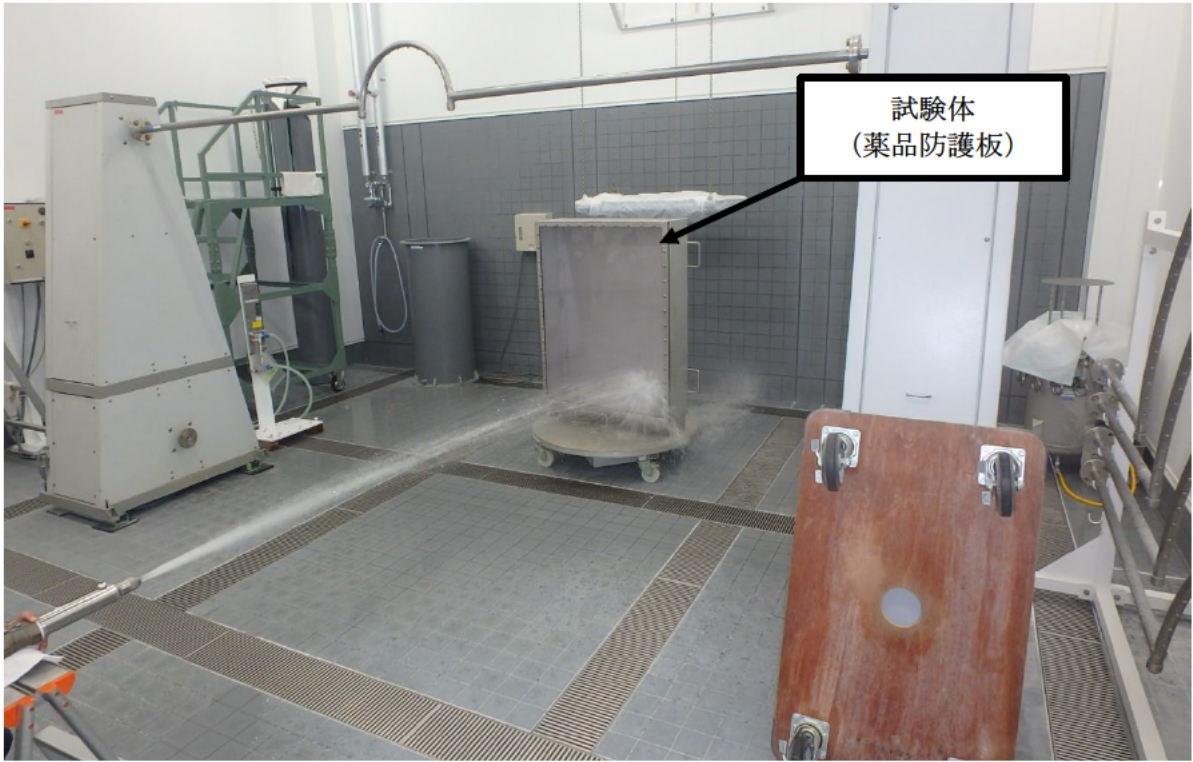
第4図 耐水試験の例 (薬品防護板)
