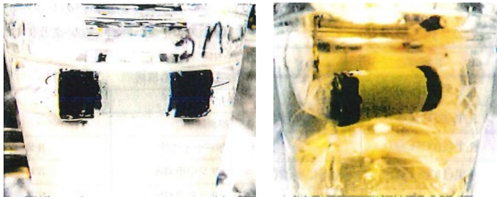
図2 塗装配管の浸漬・曝露試験状況
