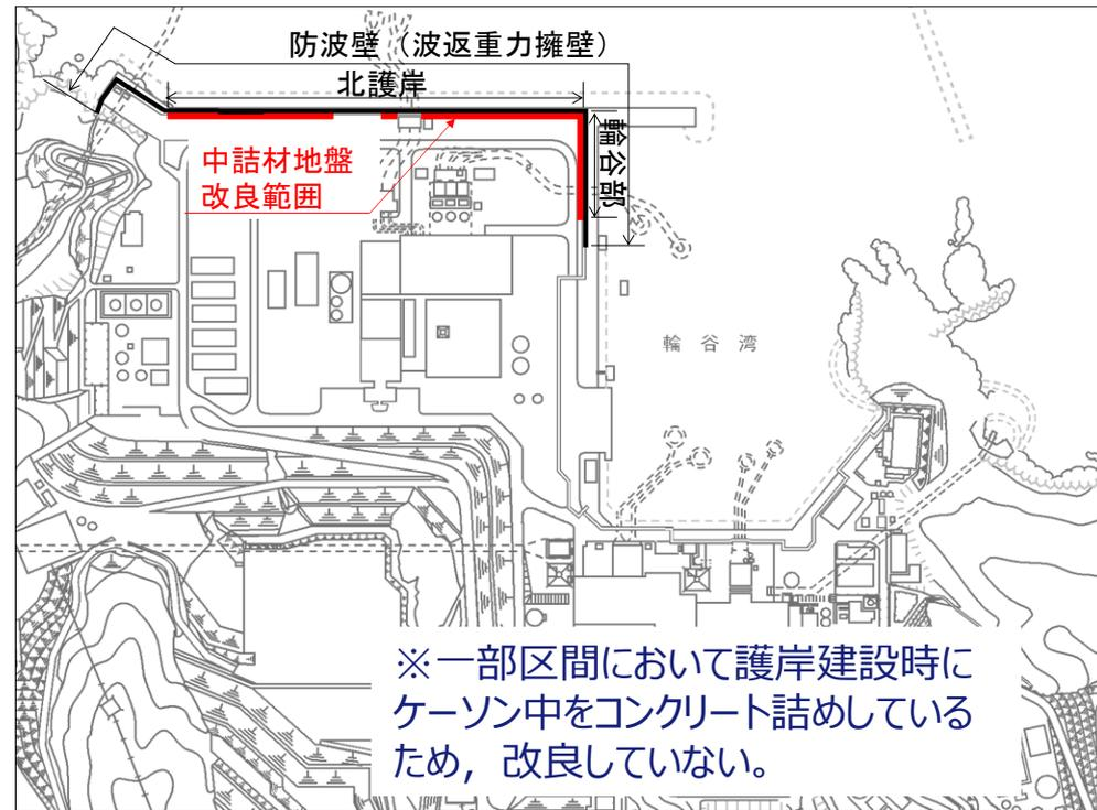
※一部区間において護岸建設時にケーソン中をコンクリート詰めしているため、改良していない。
