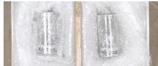
コア写真(改良地盤①～③用室内配合試験)
