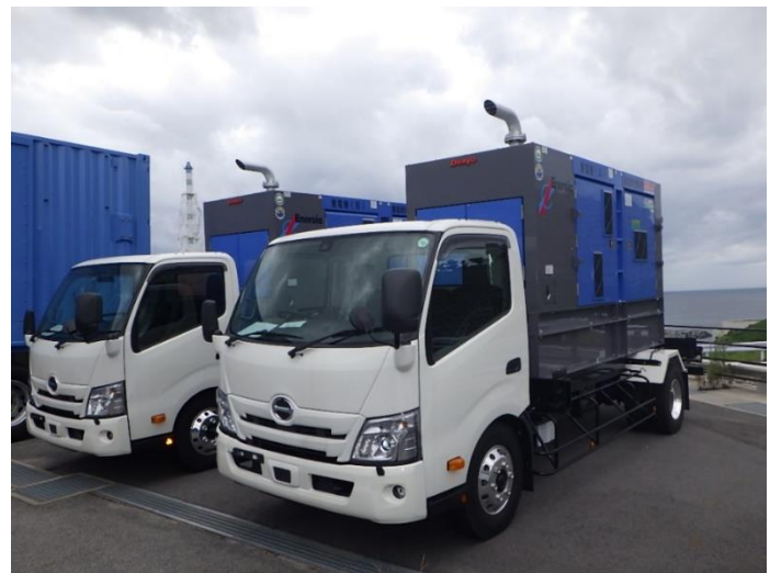
緊急時対策所用発電機
