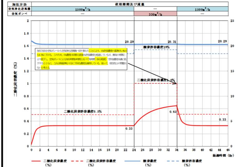
図 4-9 緊急時対策所本部内酸素濃度及び二酸化炭素濃度推移 (放射性雲通過中, 10 時間空気ポンベ加圧設備 (空気ポンベ) に切替える場合)
