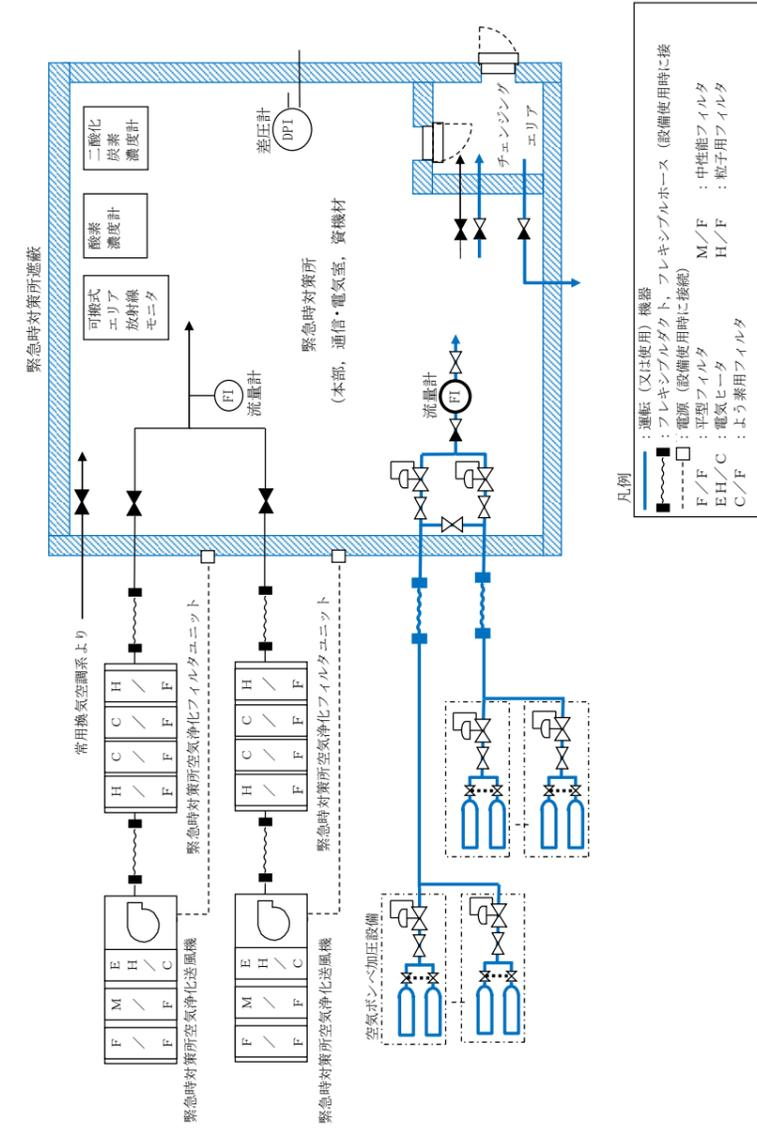
図 3-2 緊急時対策所換気空調設備 系統概略図
