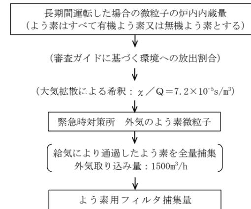
緊急時対策所空気浄化フィルタユニットのよう素用フィルタ捕集量評価の過程
