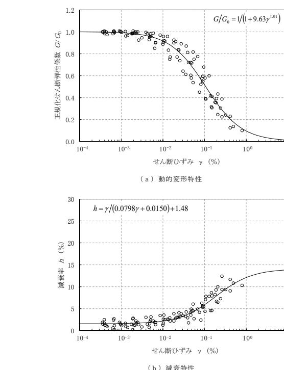
第3-1図 (4) 変形特性のひずみ依存性 (流動化処理土A)
