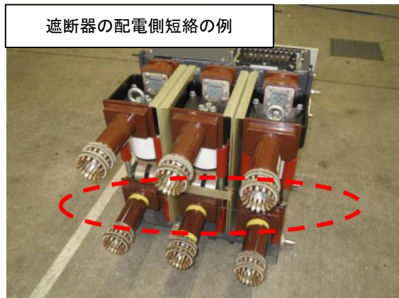
図4-5-1 遮断器の短絡箇所 (M/C 試験時)
