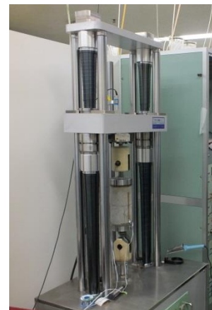
図14 付着力試験装置の概要 (レベルコンクリートー基礎コンクリート)
