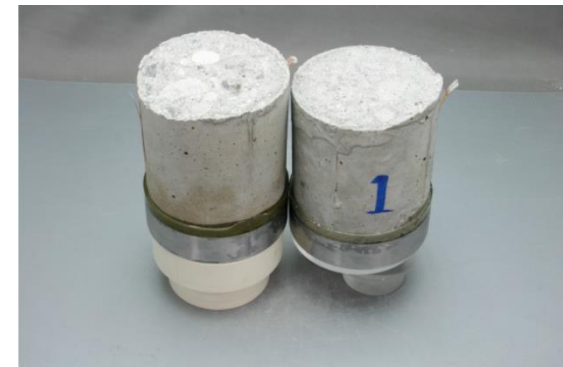
図18 試験後の破断面の状況の例 (レベルコンクリート-基礎コンクリート)
