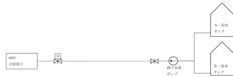
(b) 66kV 送電線引留部の碍子
