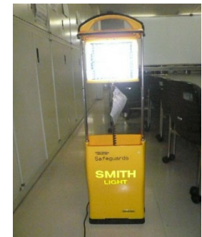
仮設照明(蓄電池式)
